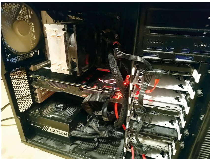
Kuva 4. Vaatimaton syväoppimislaboratorioni: Asus GeForce GTX 1070 STRIX -näytönohjain, Intel Core i7-6700 -suoritin, 16 Gt DDR4 RAM-muistia, 2 Tt kiintolevy Linuxille, 1 Tt kiintolevy Windowsille ja 2 Tt jaettu kiintolevy.
